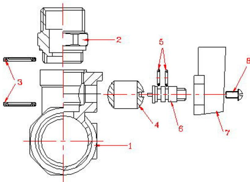
Коллекторы *VTc.580.N* и *VTc.580.NE* состоят из латунного никелированного корпуса *1*, к которому на метрической резьбе присоединены выходные патрубки *2* с наружной дюймовой резьбой. Соединение корпуса с патрубком герметизировано пропиленметакрилатным клеем анаэробного твердения *Loctite* (допущен для контакта с пищевыми жидкостями). Внутри корпуса между прокладок из PTFE (тефлона) *3* расположен шаровой латунный хромированный затвор *4*. Затвор приводится в движение латунным штоком *6*.
